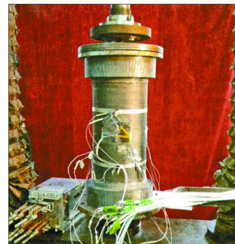
Цилиндрическая углепластиковая оболочка — образец одного из компонентов корпуса твердотопливного ракетного двигателя — в испытательной установке
