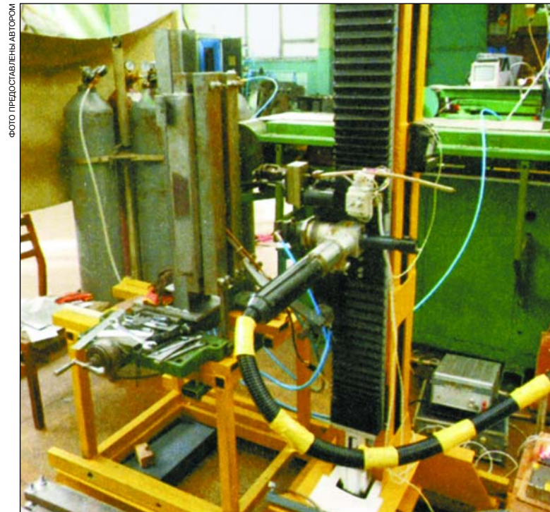
Лабораторный стенд для отработки технологии лазерной сварки сопловых блоков жидкостных ракетных двигателей
